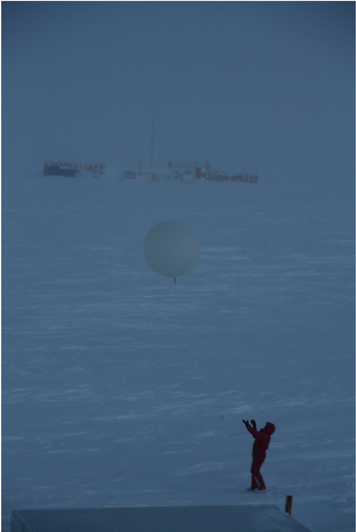
Foto 16: Lancio del pallone per il radiosondaggio meteo. Foto di Yann Reinert
