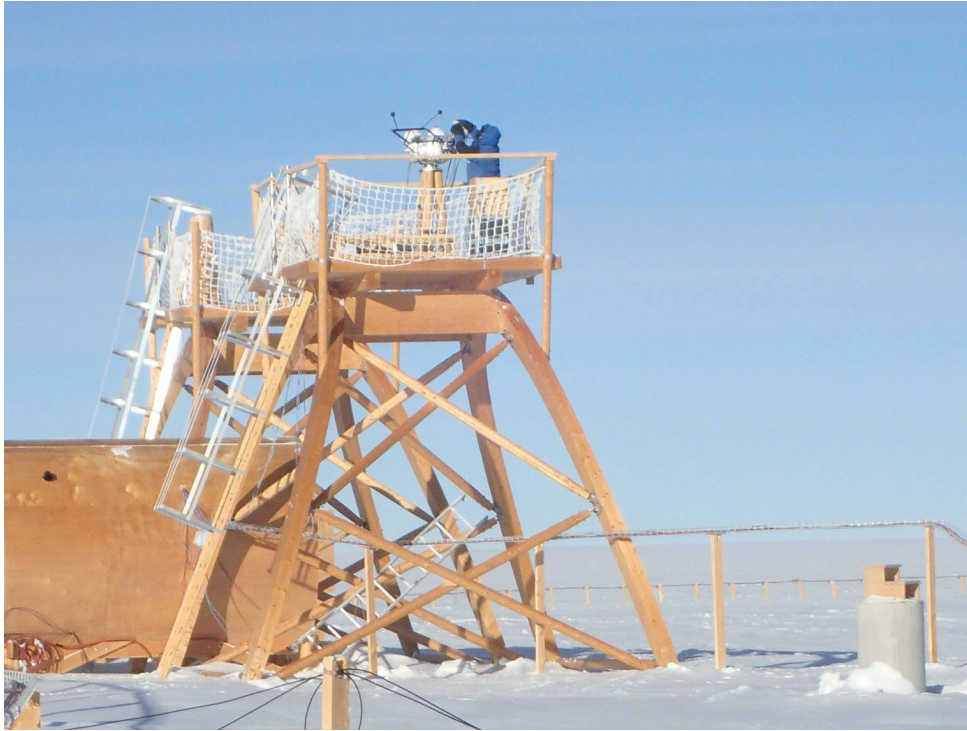
Foto 24: Manutenzione della stazione BSRN (Baseline Surface Radiation Network) posizionata sopra allo shelter Astroconcordia. Foto di Elvio Lazzarini
